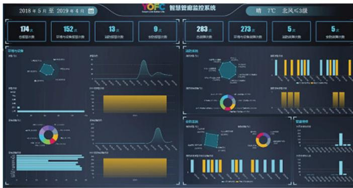
长飞 ACU 管理系统采用雷达图、条形图、趋势图、饼图、柱状图等形式，从多个维度对接入 ACU、传感器及工业设备运行状态、运维管理、报警、故障等信息进行统计，并且结合大数据分析技术，提供趋势预测等功能。
